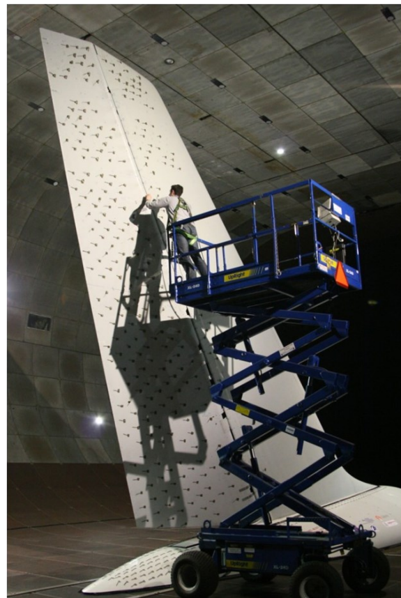
Garntofsar fästs på stjärten av en Boeing 757 i en NASA Ames vindtunnel för att visa strömningen över stjärten.
