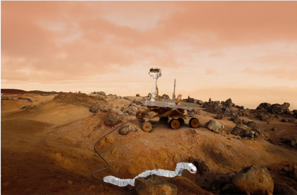
Ormroboten kan lösgöra sig från rovern och krypa in i trånga, svårtillgängliga områden. Bild SINTEF ICT
