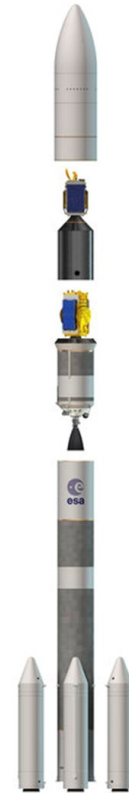
Den nya raketerna kommer att bestå av ett ombyggt centralsteg från den gamla Ariane 5, ett nytt övre steg och två eller fyra strap-on boosters från den mindre Vega-raketerna. (Bild ESA)
