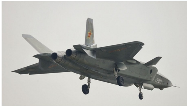
J-20 konfigurationen är anmärkningsvärd med stora nosvingar långt fram på kroppen.
