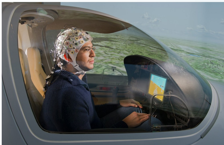
Simulering av en hjärnkontrollerad flygning vid Institute for Flight System Dynamics Munich (Foto: A. Heddergott / TU München).
