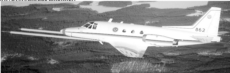
CARABAS II under flygegenskapsutprovning. I nosen syns de båda 8 m långa antennrören tillverkade av aramid förstärkt Epoxi (Foto: Pia Ericson, FMV:Prov)
