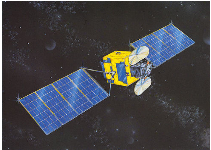
Figur 6 Tele-X som den slutligen såg ut. 19 meter mellan solpanelspetsarna och en tomvikt på 1050 kg
