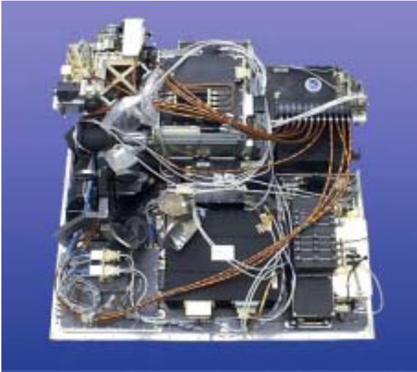
SMR. Den första av världens två submm-mottagare för atmosfärmätningar från rymden.
