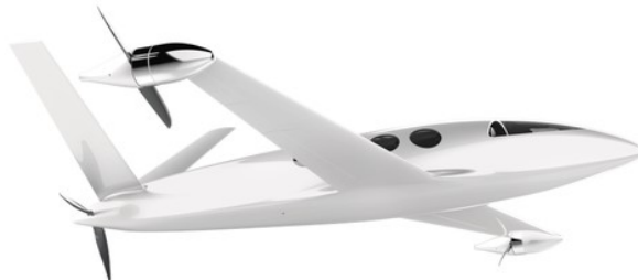
Alice har en motor på varje vingpets och en i aktern
