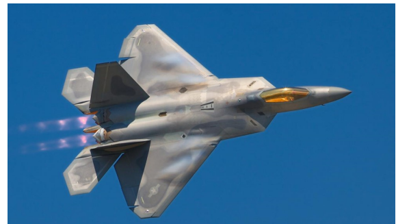
F-22 med placering av vinge och roderytor för liten radarsignatur
