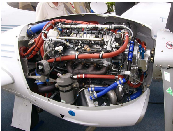
Thielert byggd på Mercedes 4 cyl dieselmotor
