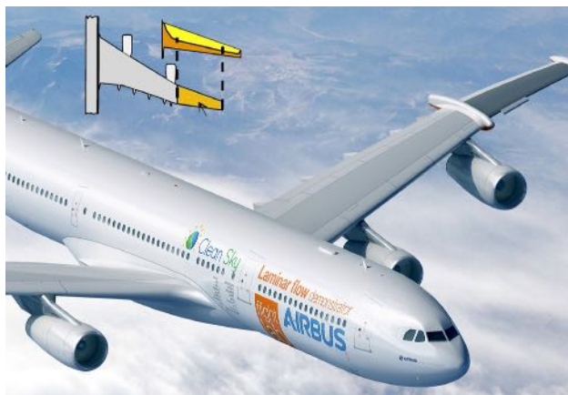
Flygprov med Saabs laminärvinge på Airbus A340.
